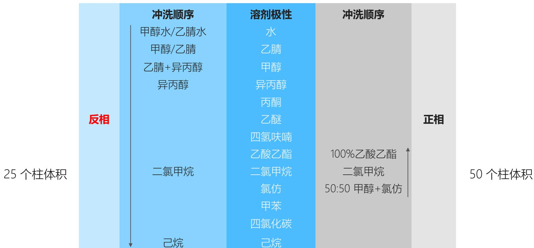
Tips: 冲洗的流速应根据系统压力作适当调整，不得超出色谱柱耐受压力上限
